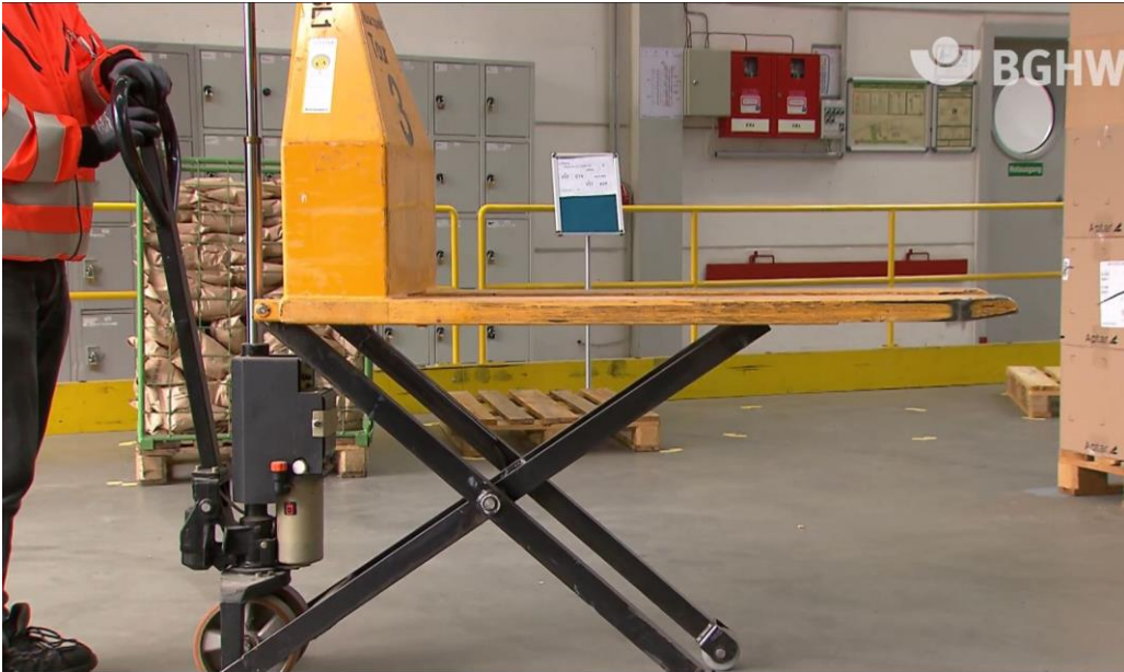
Abbildung 3: Scherenhubwagen zum Anpassen der Arbeitshöhe aus Kompendium
