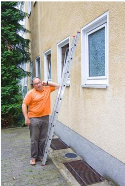
Abbildung 5: sicherer Anstellwinkel einer Sprossenleiteleiter 65° bis 75°
